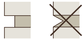
richtiges Auskratzen der Fuge!
